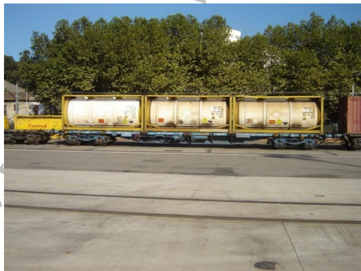
Figura 16. Vagón de la clase S (Sgss).
