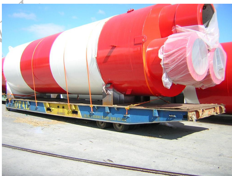
Figura 5. Roll-trailer de 60 t de capacidad de carga.
