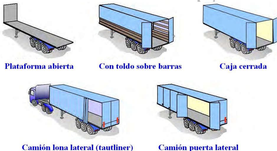
Figura 11. Diferentes tipos de semirremolques 7 .
