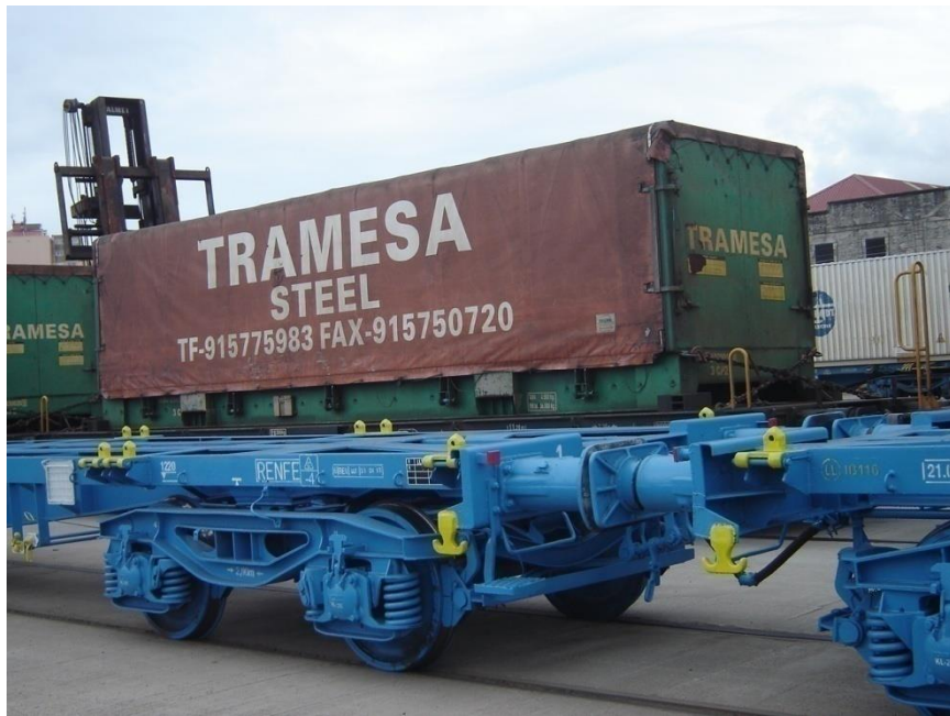
Figura 8. Caja móvil de la clase B (30').
