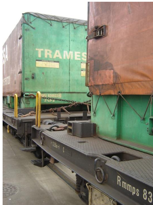
Figura 15. Vagón de la clase R (Rmmps).
