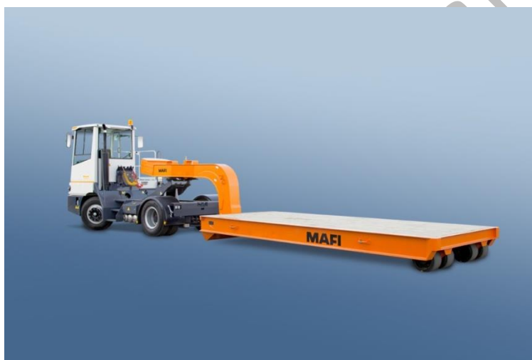
Figura 4. Tug-master (cabeza tractora) y roll-trailer (plataforma).
