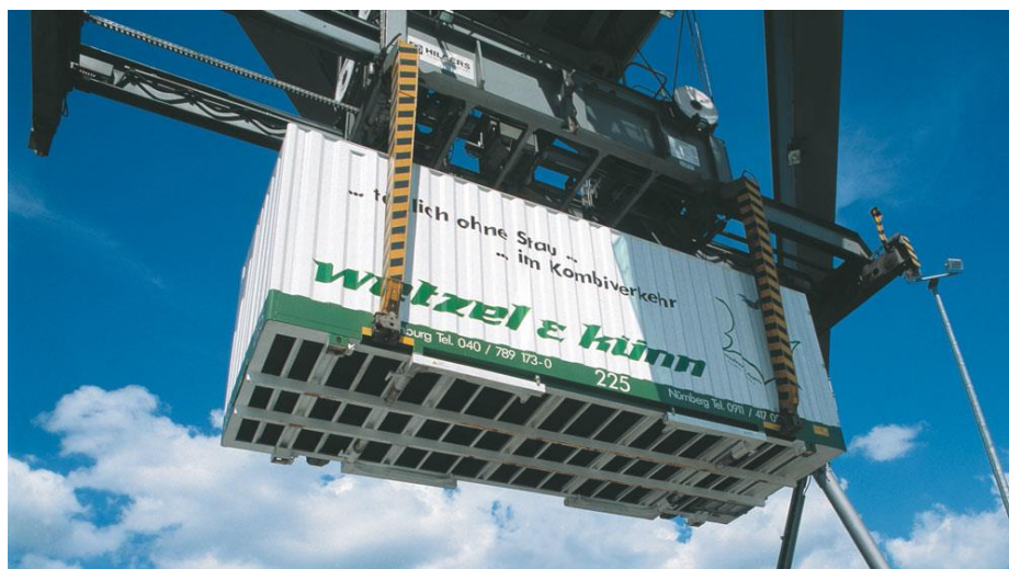
Figura 7. Sistema de manipulación de cajas móviles.
